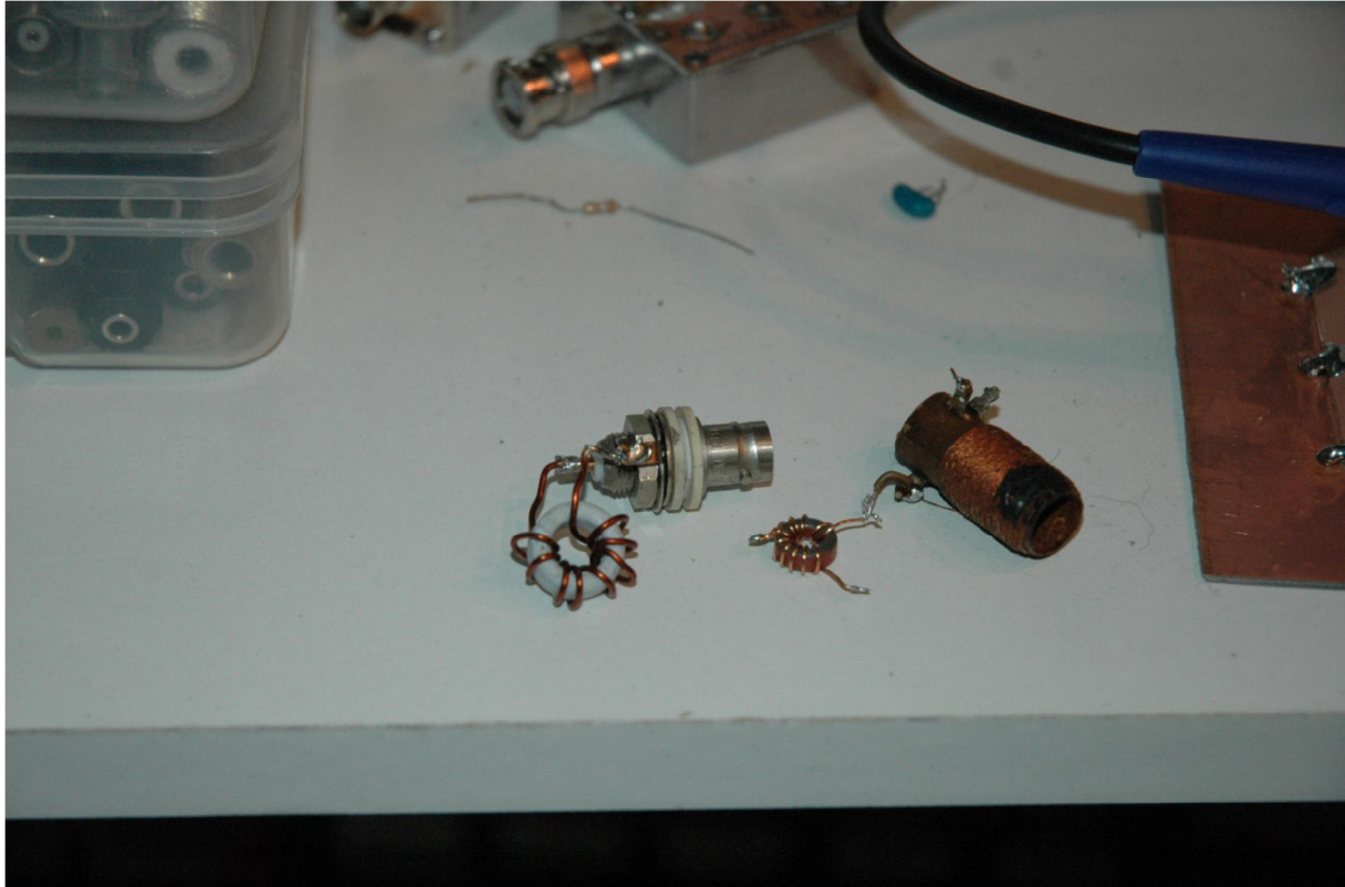
De gauche à droite, Bobine B sur un tore 4C6, (la BNC est destinée à des tests que nous aborderons plus tard), puis la bobine C, plus petite, sur tore en poudre de fer T34-2, et la bobine D récupérée d'une antenne à cadre de ferrite d'un vieux poste radio
