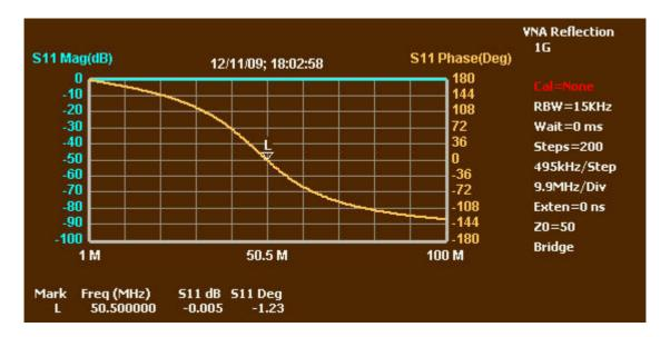
6 - Il est possible que les axes soient inversés. Ce diagramme a été obtenu avec l'axe primaire réglé à 1 (en utilisant "Setup => Primary Axis"). En fait, le marqueur "L" n'est pas encore présent. Sélectionnez le marqueur L ou "None" et double-cliquez à l'endroit où le graphe de phase passe par zéro. Utilisez ensuite les boutons + et - du marqueur pour l'amener aussi près que possible de la phase zéro.
