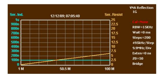
5 – L'inductance reste plate à 100 nH, mais la résistance augmente maintenant avec la fréquence. Double-cliquez sur l'axe de l'inductance pour ouvrir la fenêtre de l'axe Y et choisissez "Series Reactance" dans "Graph Data". Placez le marqueur L s'il ne l'est pas. Voici le nouveau graphe :
