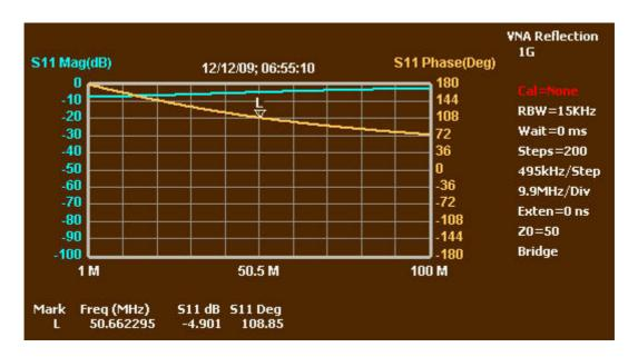
Lorsque la fréquence augmente, le circuit RL ressemble de plus en plus à une inductance pure, et l'amplitude de  $S_{11}$  tend vers 0 dB (coefficient de réflexion de 1). L'évolution est plus intéressante à voir sur le diagramme de Smith :
